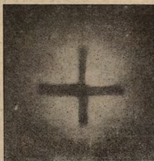
Fig. 7. Krzyżyk ołowiany, położony wprost na kliszy, owiniętej w kopertę z papieru czarnego; źródło światła [pudełeczko z 0,01 soli radowej] umieszczono w odległości 2 ctm.
