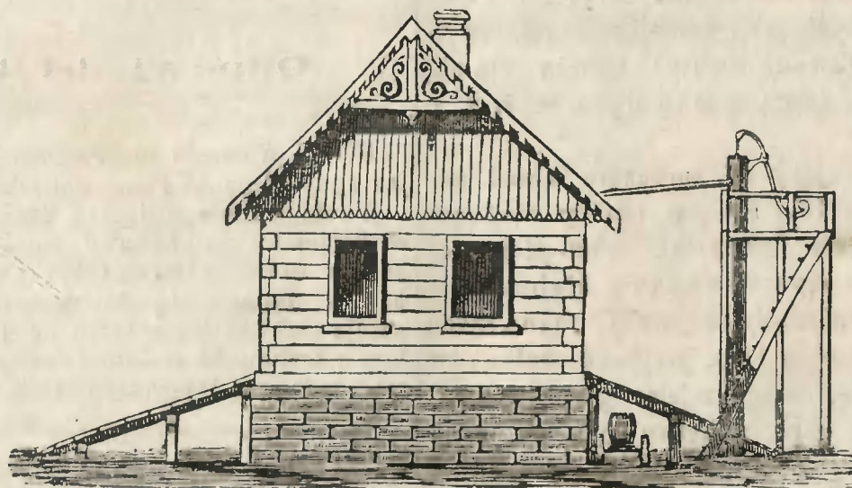
Elewacja boczna. (Schody z obu stron, pompa i beczka).
