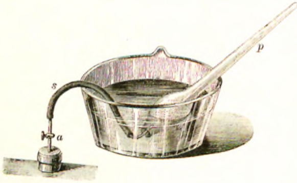
Fig. 98. p Aërodecker-Rohr. a Abblaserrohr mit Hahn auf dem Mischgefäß. s Gummischlauch mit gekrümmtem Glasrohransatz.
