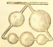
Fig. 7. Kali-Apparat nach LEIBIG .
