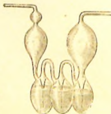
Fig. 8. Kali-Apparat nach GEISSLER .
