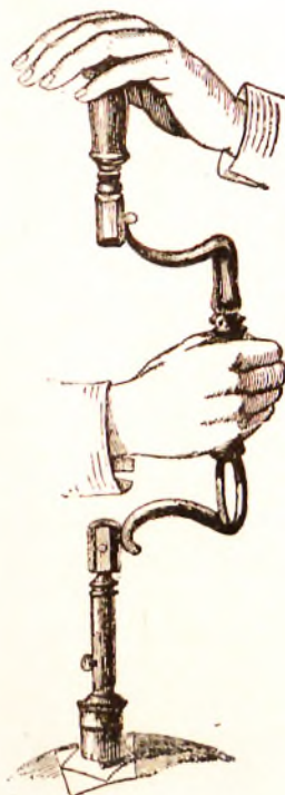
Ryc. 6. Zastosowanie wiertnika (trepana) łukowatego.
