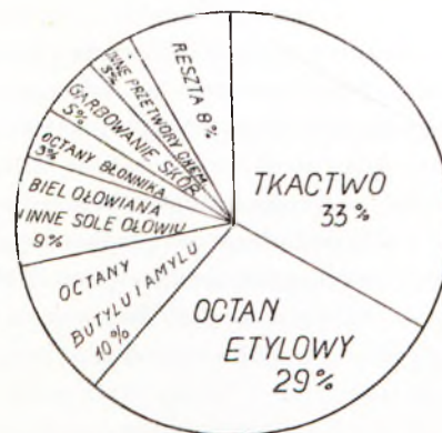
Ryc. 206. Rozdział kwasu octowego w przemyśle.
