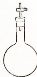
Ryc. 60. Pomiar gęstości gazu.
