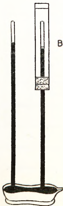
Ryc. 83. Pomiar prężności pary wodnej.
