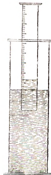
Ryc. 53. Pomiar objętości gazu.
