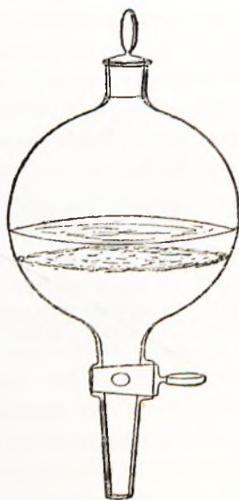
Ryc. 88. Częściowa rozpuszczalność wody i eteru.
