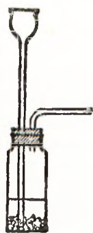
Ryc. 67. Przyrząd do wytwarzania wodoru.
