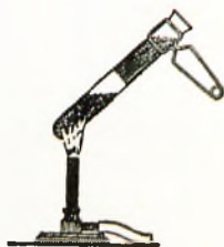
Ryc. 10. Ogrzewanie tlenku rtęciowego.
