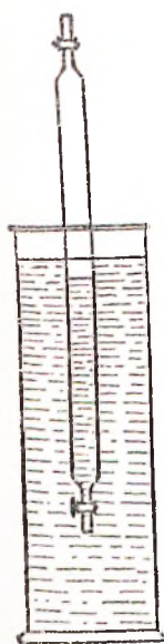
Ryc. 110. Pochłanianie chloru z mieszaniny H_2-Cl_2 , roztworem jodku potasowego.
